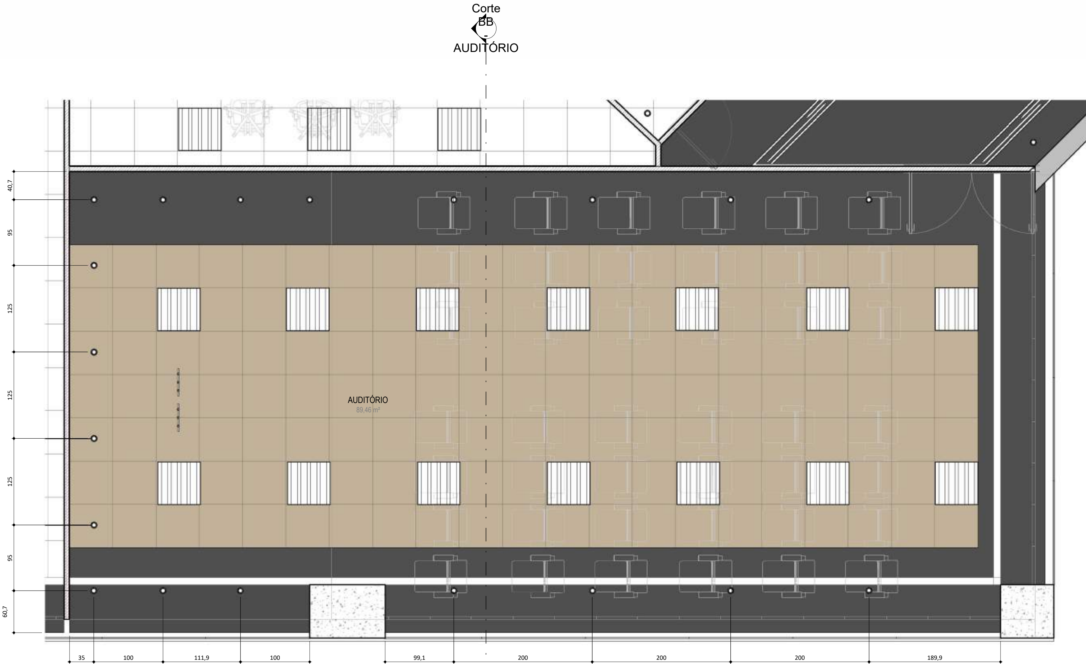
DET_PLANTA DE FORRO - AUDITÓRIO ESCALA 1:30
